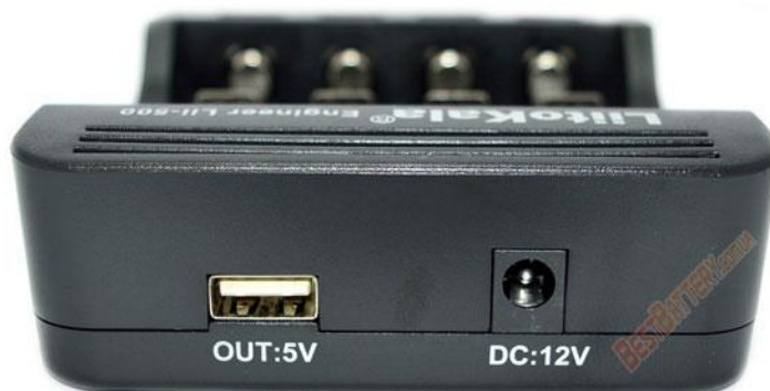
Рисунок 5 - USB выход 5V 1A для зарядки внешних устройств.
