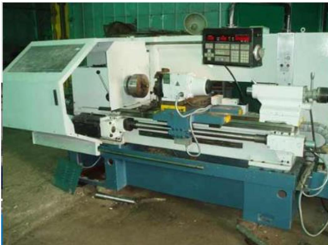
Рисунок б – Токарный станок с ЧПУ 16К20Ф3
