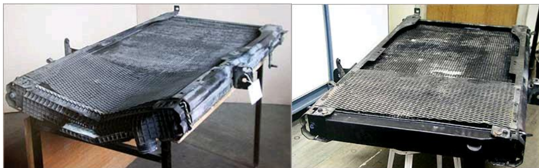
Рисунок 6 – Радиатор после аварии (а) и восстановленный радиатор (б)
