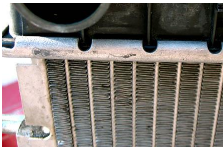
Рисунок 4 - Радиатор с цельнопаянной сердцевиной и пластмассовыми бачками
