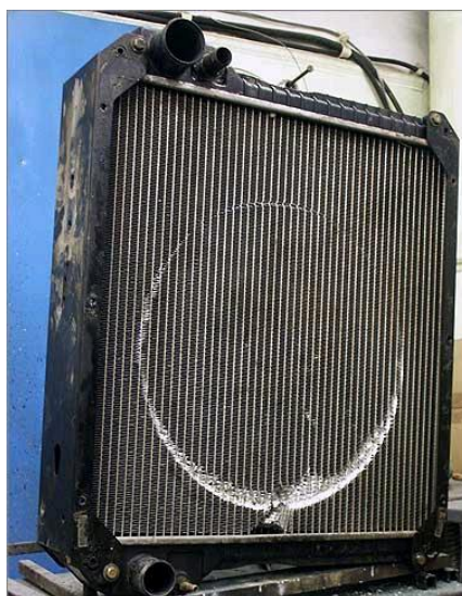
Рисунок 5 – Повреждение радиатора автомобиля вследствие ударного действия крыльчатки вентилятора
