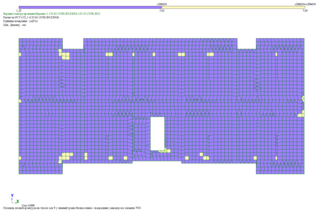
Рисунок Б.4 – Величина требуемого армирования по оси Y у нижней грани
