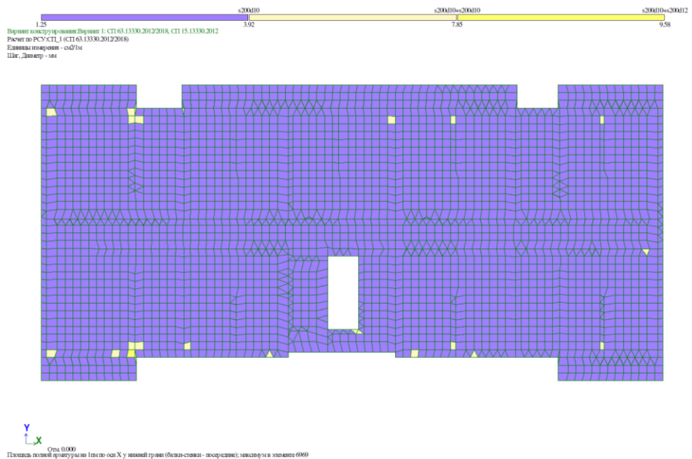
Рисунок Б.3 – Величина требуемого армирования по оси X у нижней грани
