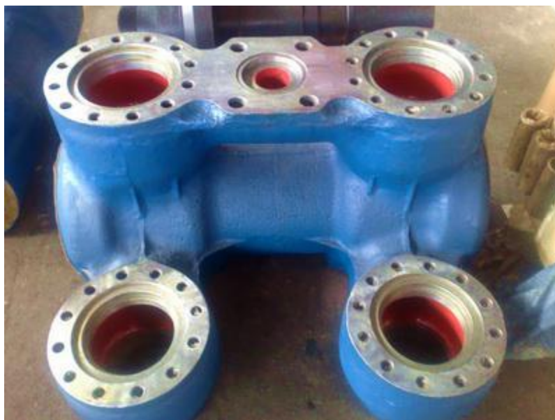
Рисунок 2 – Многоцилиндровая гидравлическая коробка бурового насоса
