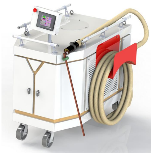
Рисунок 16 – Установка индукционного подогрева
