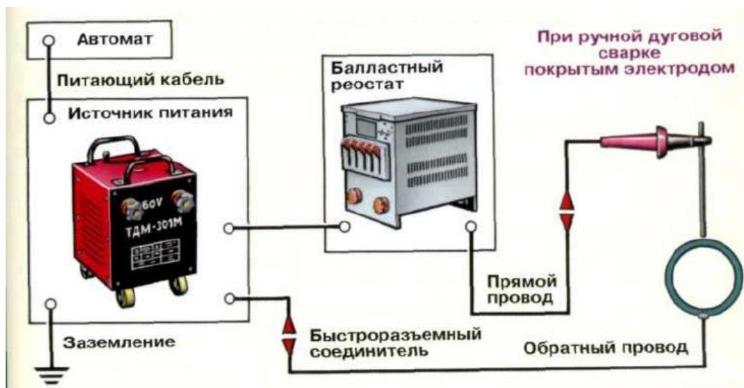
Рисунок 17 – Схема выполнения ручной дуговой сварки
