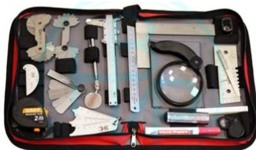
Рисунок 29 – Набор для проведения визуального контроля
