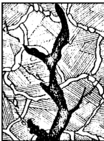
Рисунок 8 – Трещины, обусловленные действием ударных нагрузок
