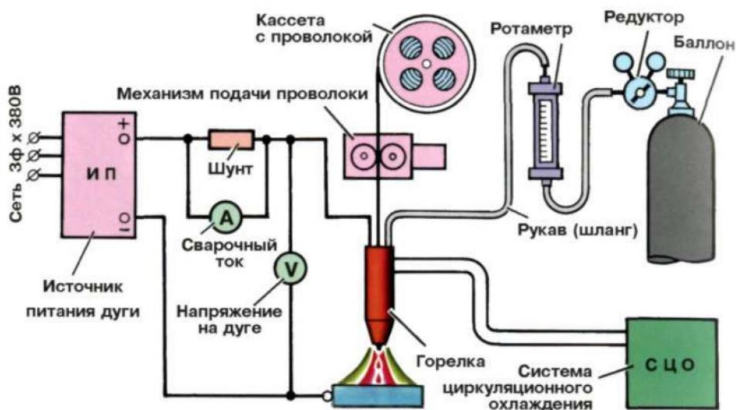
Рисунок 18 – Схема выполнения механизированной сварки в защитных газах
