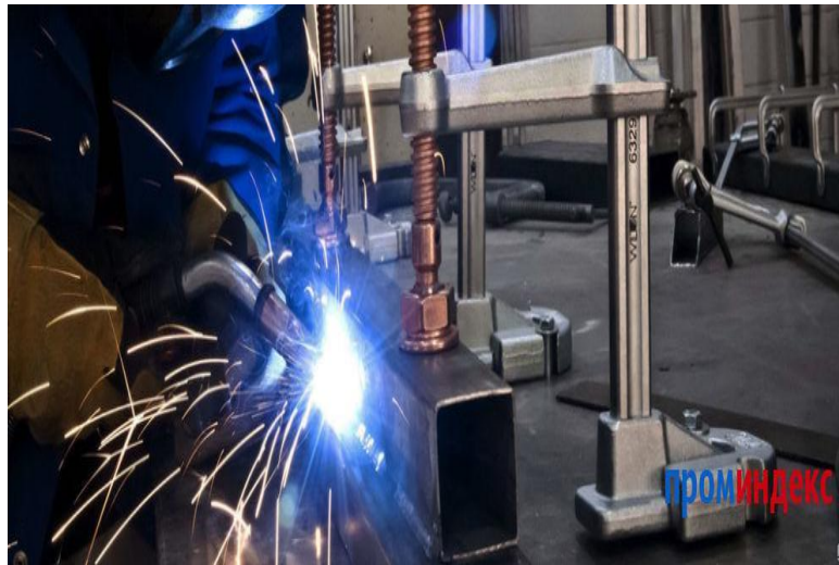
Рисунок 13 – Сварка конструкции стойки
