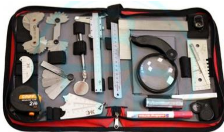
Рисунок 19 – Набор для проведения визуального контроля
