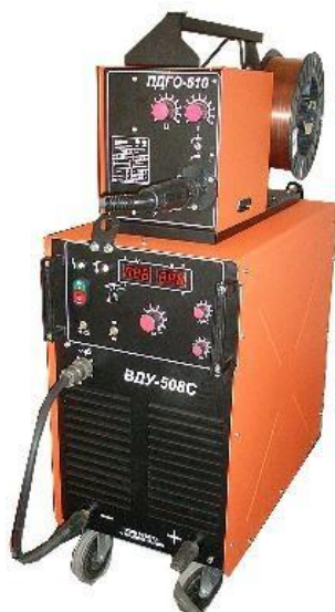
Рисунок 5 – Оборудование для выполнения механизированной сварки: выпрямитель ВДУ-508 и полуавтомат ПДГО-510
