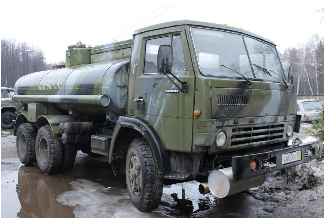
Рисунок 1 – Внешний вид армейского бензовоза на базе КАМАЗ 5320 с цистерной АЦ-9
