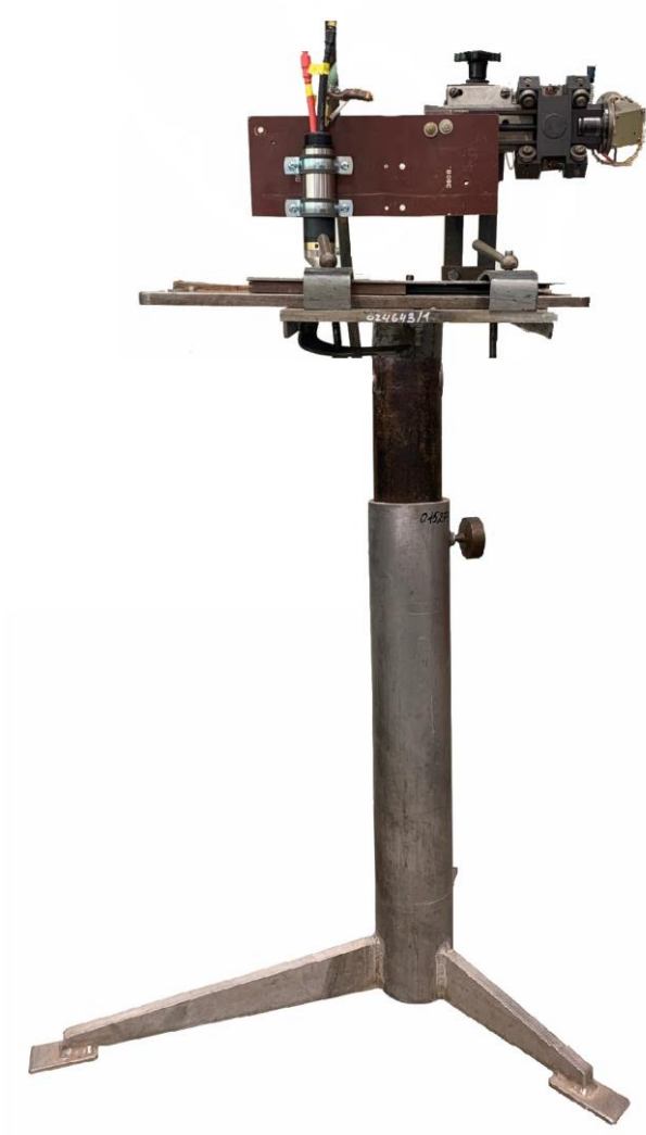
Рисунок 27 – Внешний вид лабораторной стойки для автоматической сварки неплавящимся электродом свободной и сжатой дугой
