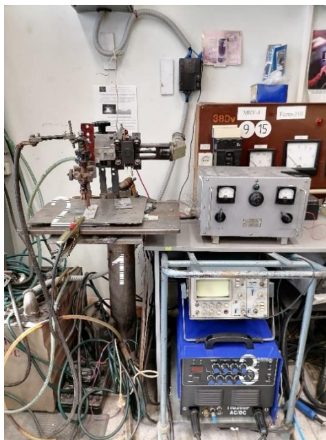
1 - лабораторная стойка, 2 - горелка, 3 - инвертор TIG 250
