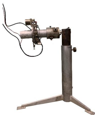
а) сварочного поста с автоматом ГНС-1
