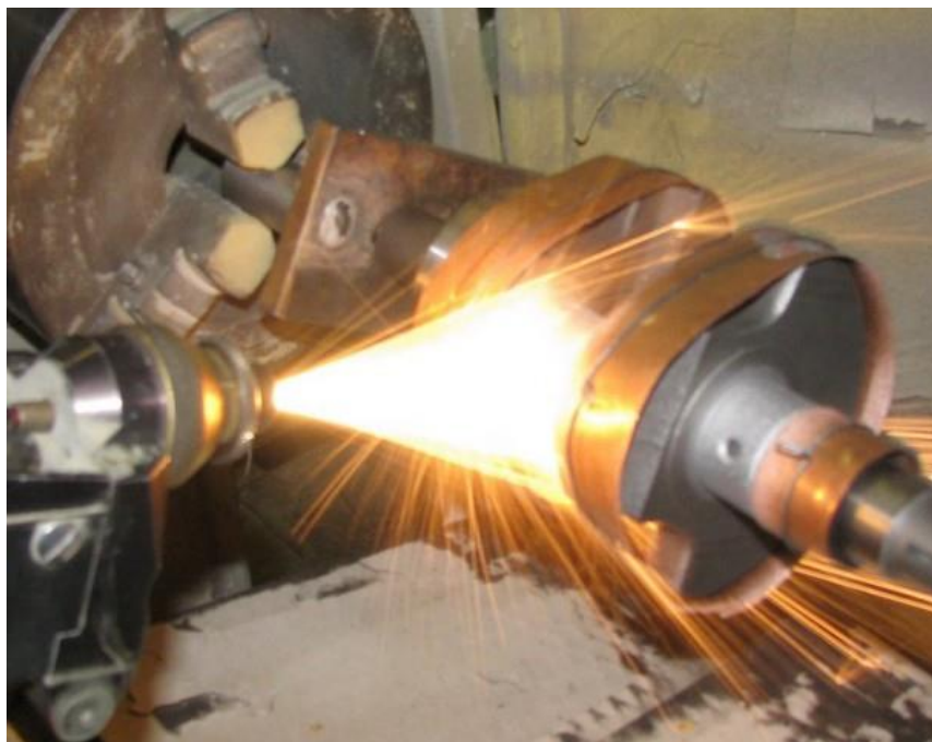
Рисунок 13 – Плазменное нанесение покрытия при восстановлении вала
