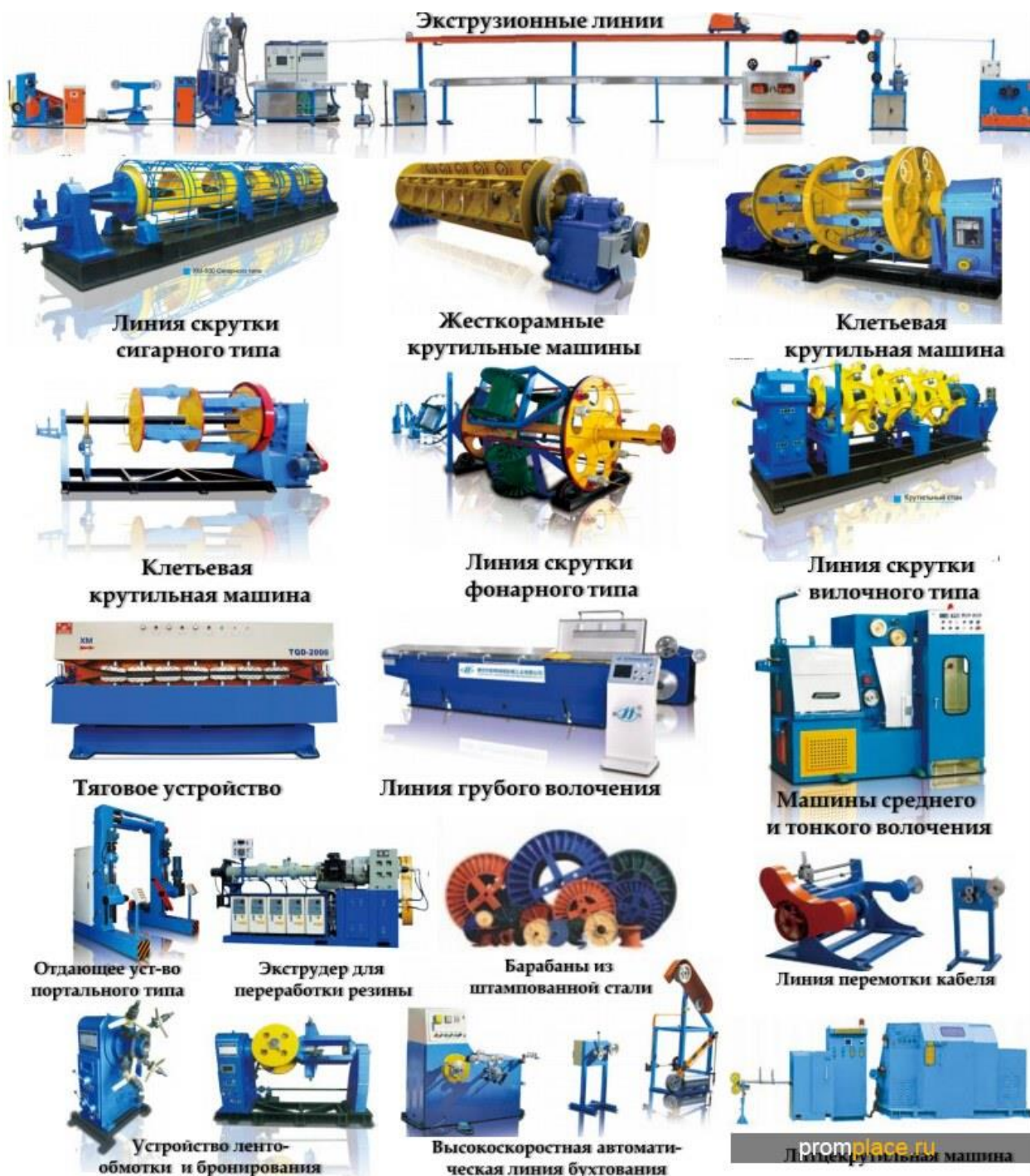
Рисунок 2 – Основное производственное оборудование, необходимое для процесса изготовления готовой продукции на предприятии по производству кабельно-проводниковой продукции
