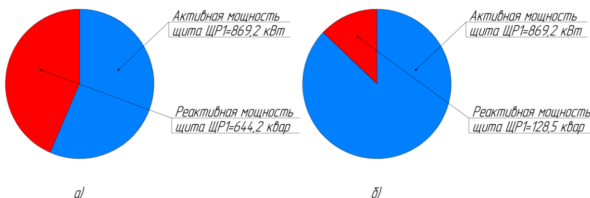
Рисунок 27 – Потребление мощности корпуса 601Д (а – до компенсации, б – после компенсации)
