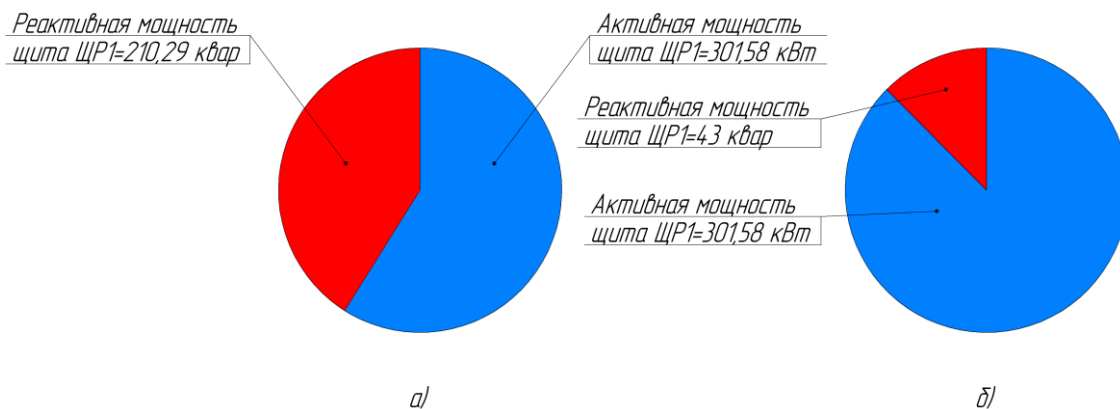
Рисунок 30 – Потребление мощности корпуса 627 (а – до компенсации, б – после компенсации)
