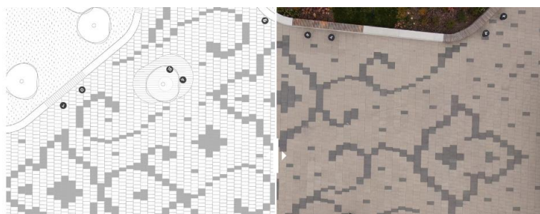
Рисунок 41 – Схема раскладки брусчатки на центральной площади, «Белые цветы», г. Казань
