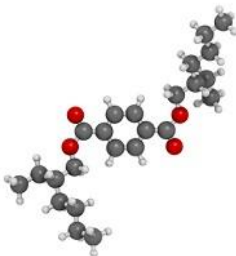
Рисунок 12 – Молекула пластификатора ДОТФ [40]
