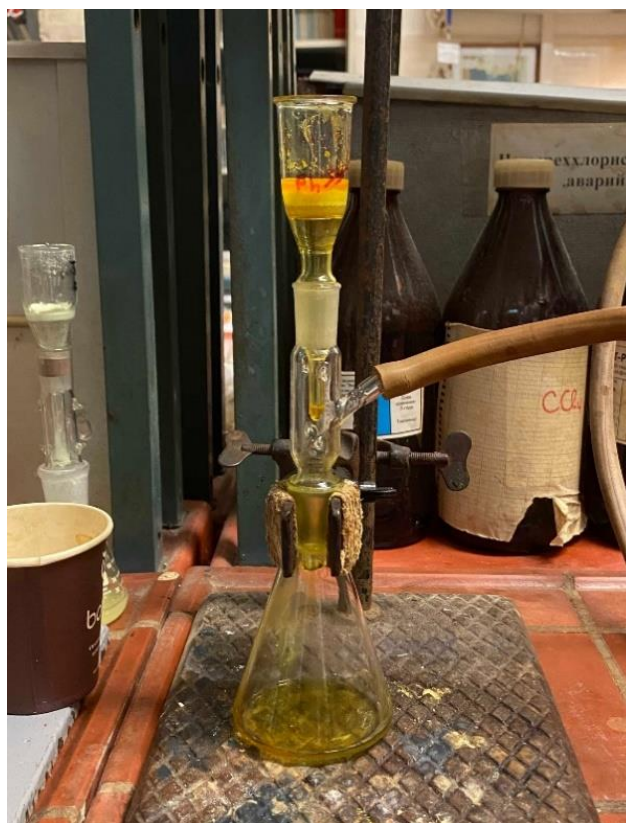
Рисунок 19 – Установка фильтрации и вакуумной осушки фенилгидразона 1,5-дифенилпент-1-ен-4-ин-3-она
