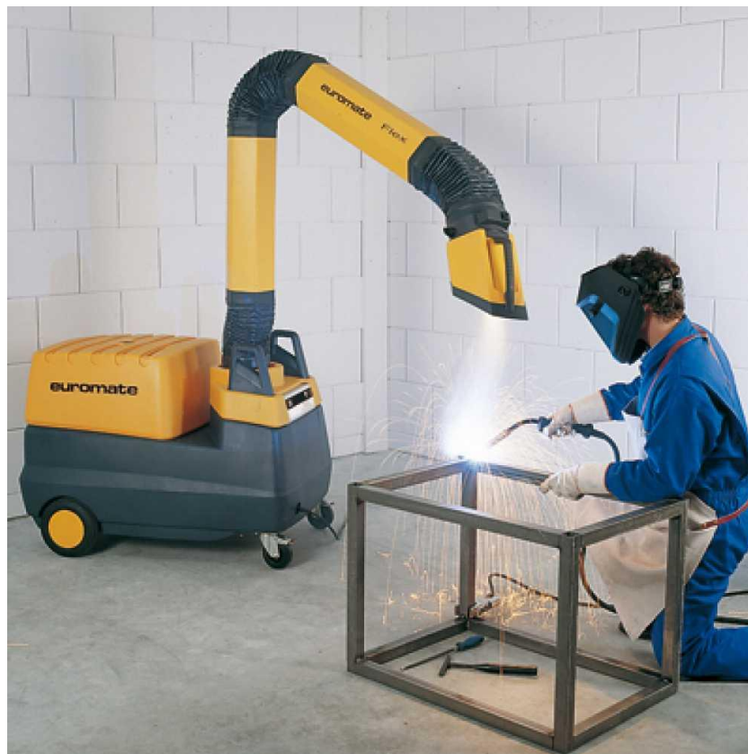
Рисунок 3 – Свободно перемещаемые вытяжки, расположенные рядом с местом работы сварщика
