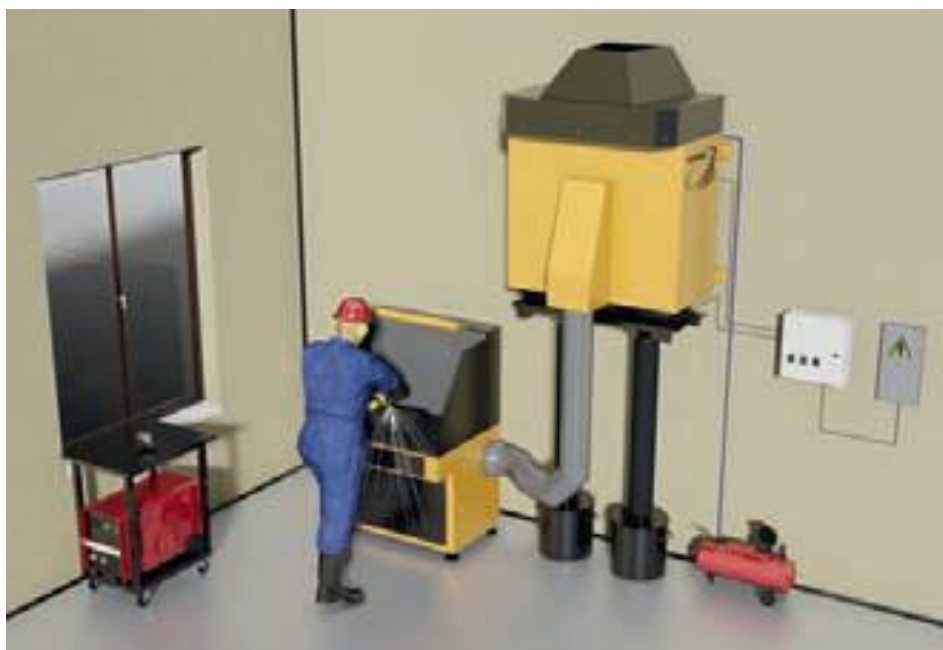
Рисунок 4 – Рабочий стол сварщика с встроенной вентиляцией
