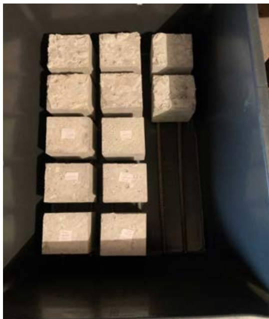
Рисунок 9 - Подготовка бетонных образцов к замачиванию в минеральном масле ТАД – 17 (трансмиссионное масло)
