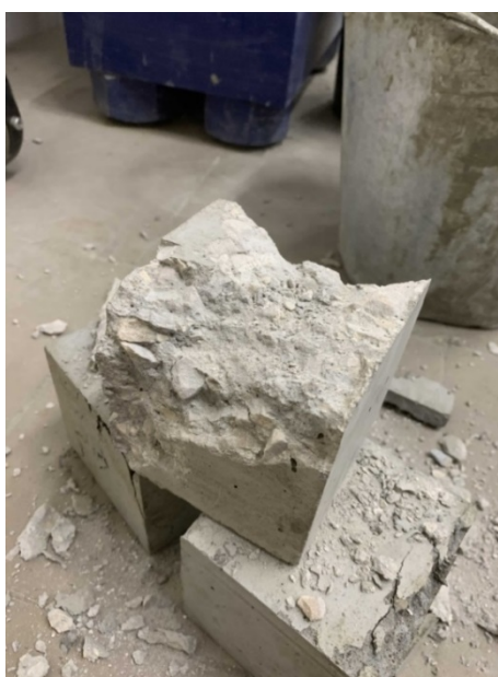
Рисунок 8б - Разрушенные контрольные образцы II-12-1к, II-12-2к
