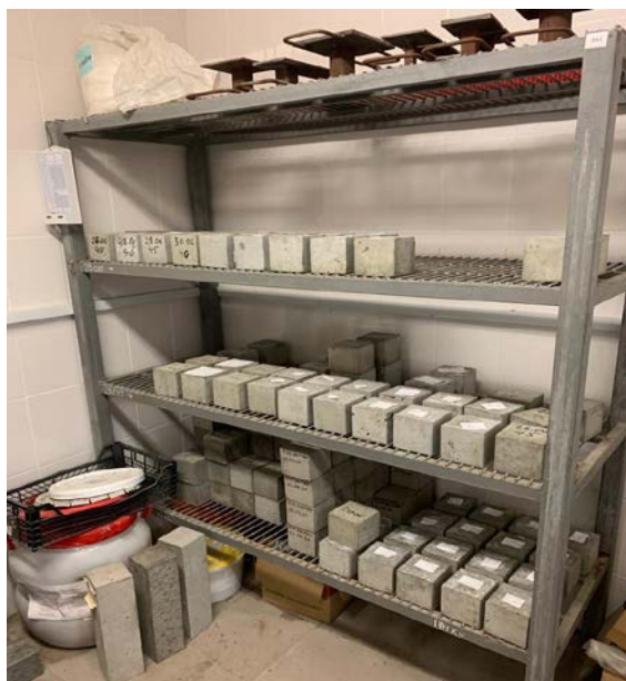
Рисунок – 5 Камера нормального твердения и влажного хранения
