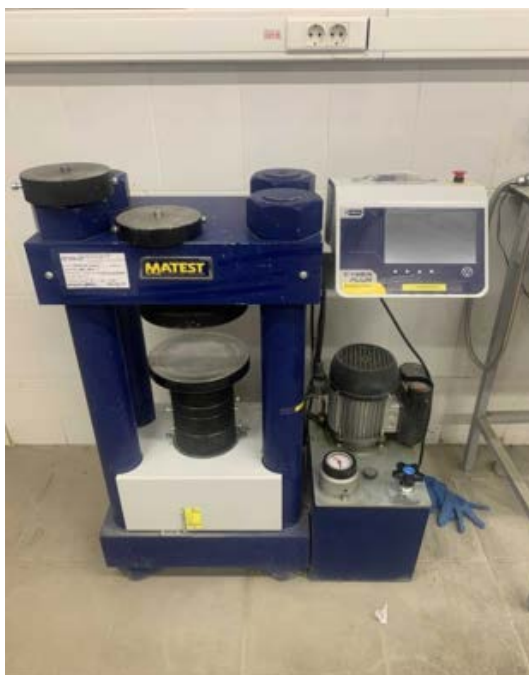
Рисунок 7 - Полуавтоматический прессы модели Cyber-Plus Evolution C109N для испытания на сжатие бетонных образцов-кубов
