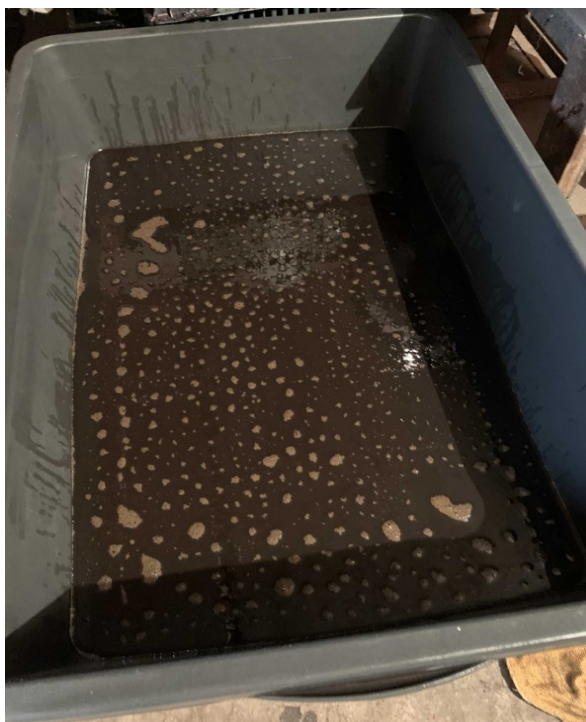
Рисунок 10 - Процесс замачивания бетонных образцов в минеральном масле ТАД – 17 (трансмиссионное масло)
