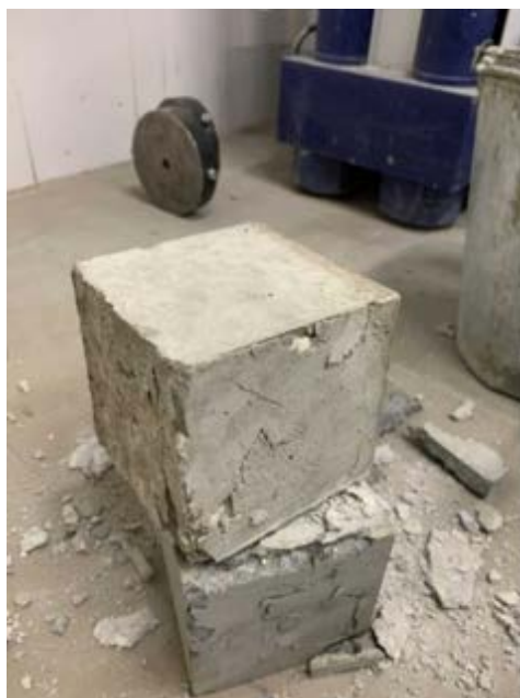
Рисунок 8а - Разрушенные контрольные образцы I-12-1к, I-12-2к
