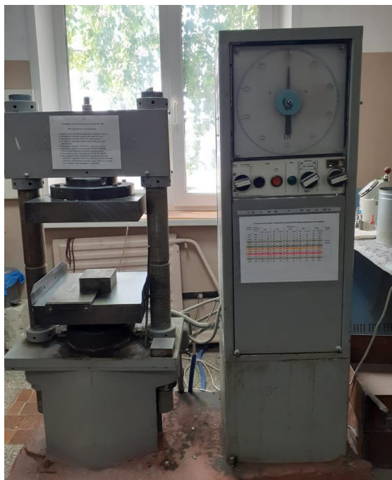
Рисунок 15 – Гидравлический пресс МС-500
