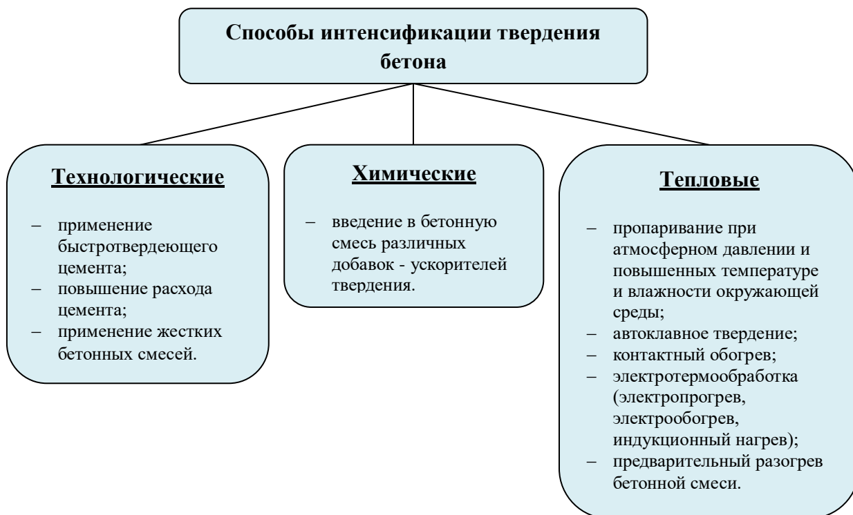
Рисунок 3 – Способы интенсификации твердения бетона
