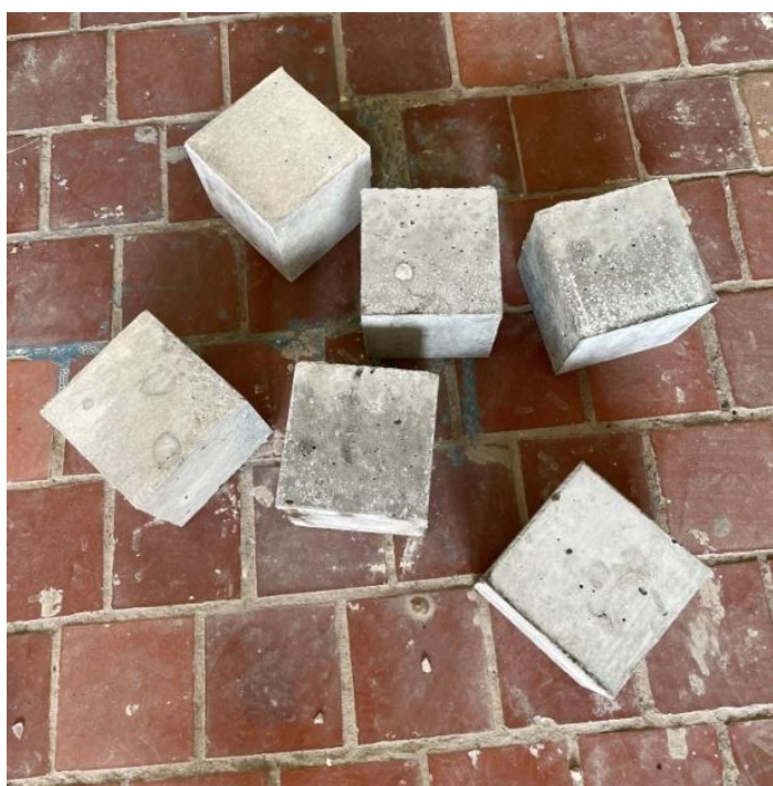
Рисунок 32 – Часть экспериментальных образцов-кубов, твердевших в нормальных условиях
