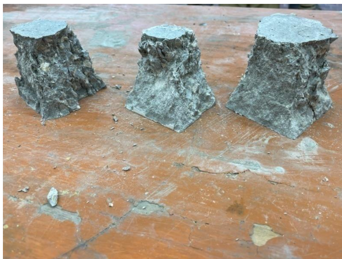
Рисунок 20 – Разрушенные контрольные образцы-кубы
