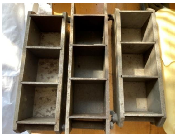
Рисунок 14 – Металлические формы ЗФК-100,0
