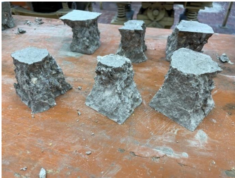
Рисунок 24 – Часть разрушенных образцов с содержанием ускорителя твердения
