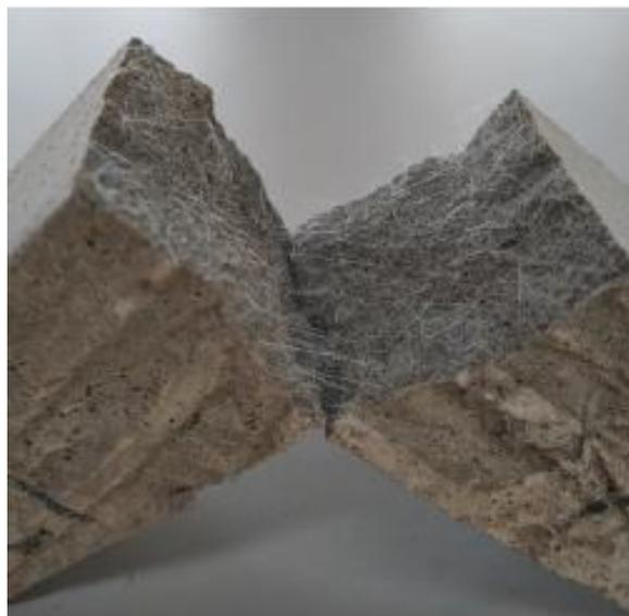
Рисунок 34 – Образец партии №28 после испытания на изгиб
