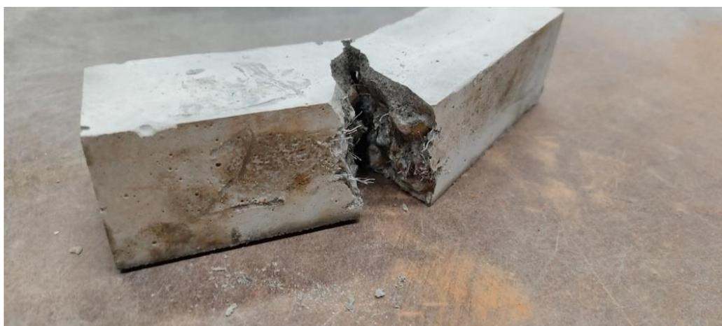
Рисунок 20 – Характер разрушения сталефибробетонного образца при испытании по прочности при изгибе
