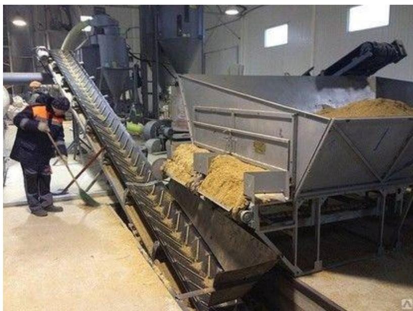
Рисунок 6 – Механизированная подача мелкодисперсного фиброволокна с помощью ленточного транспортера
