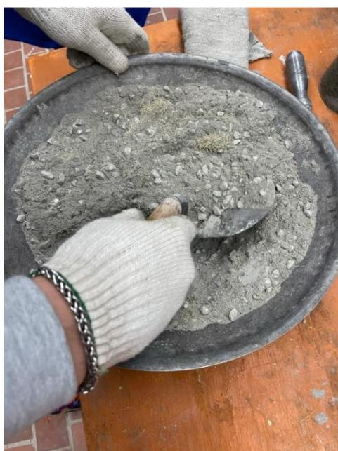
Рисунок 16 – Перемешивание компонентов фибробетонной смеси
