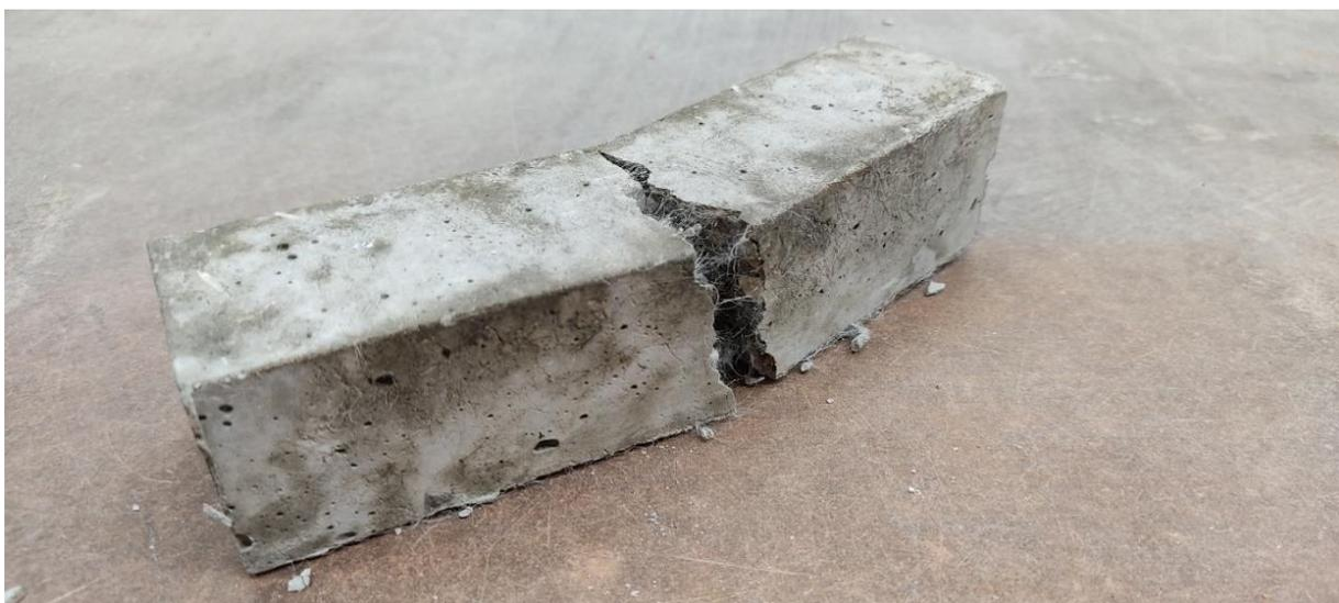
Рисунок 26 – Характер разрушения образца, армированного полипропиленовой фиброй при испытании по прочности при изгибе
