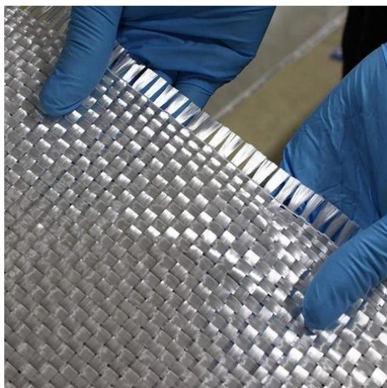
Рисунок 30 – Образец стеклоткани, используемой в качестве армирующего волокна
