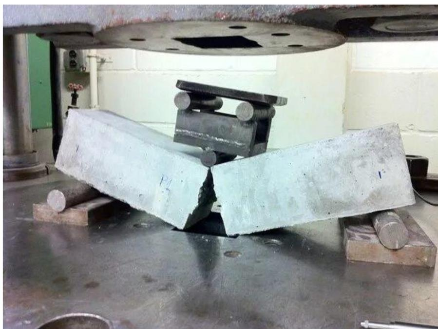
Рисунок 15 – Образец бетона в процессе испытаний по прочности на растяжение
