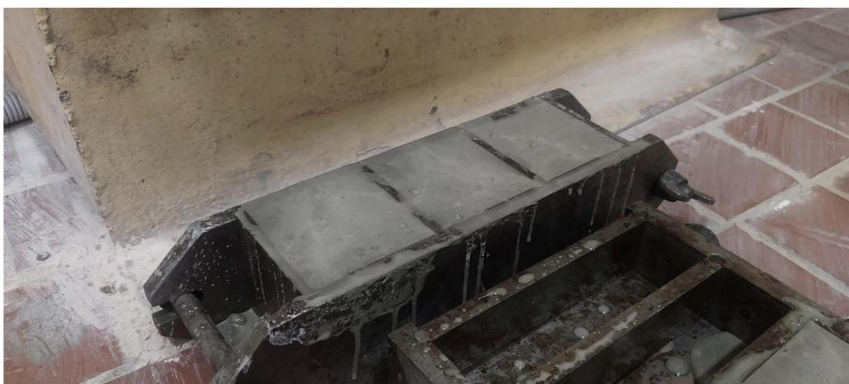
Рисунок 12 – Исследуемый состав бетона в форме для создания образцов
