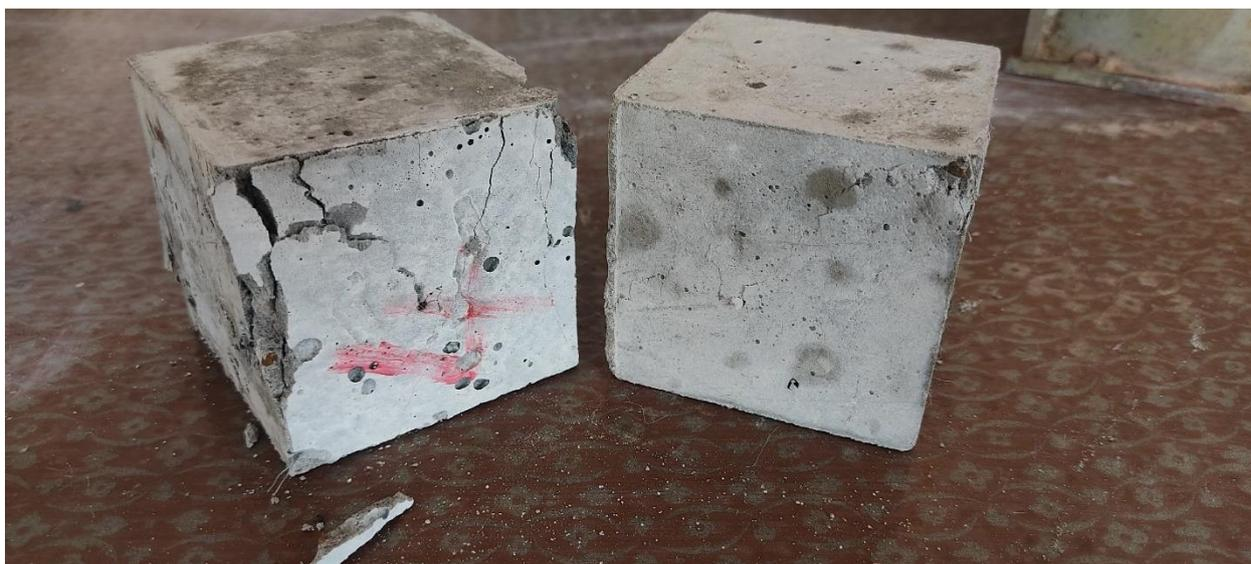
Рисунок 19 – Характер разрушения сталефибробетонного образца (слева) и образца с полипропиленовой фиброй (справа) при испытании по прочности при сжатии
