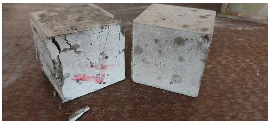
Рисунок 24 – Характер разрушения образца, армированного полипропиленовой фиброй при испытании по прочности при сжатии
