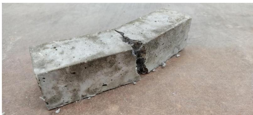
Рисунок 32 – Характер разрушения образца, армированного полипропиленовой фиброй при испытании по прочности при изгибе
