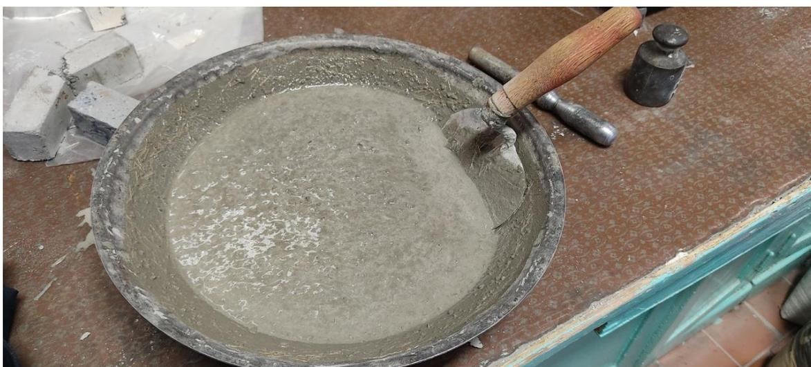
Рисунок 17 – Замес фибробетона партии 28
