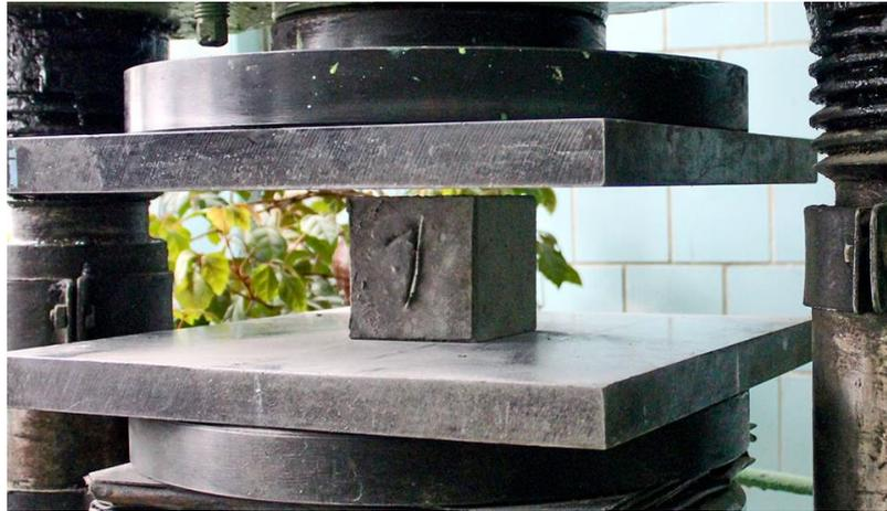
Рисунок 14 – Образец бетона в процессе испытаний по прочности на сжатие
