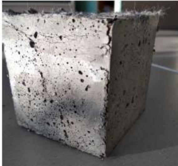
Рисунок 33 – Образец куба со стекловолокном после испытания
