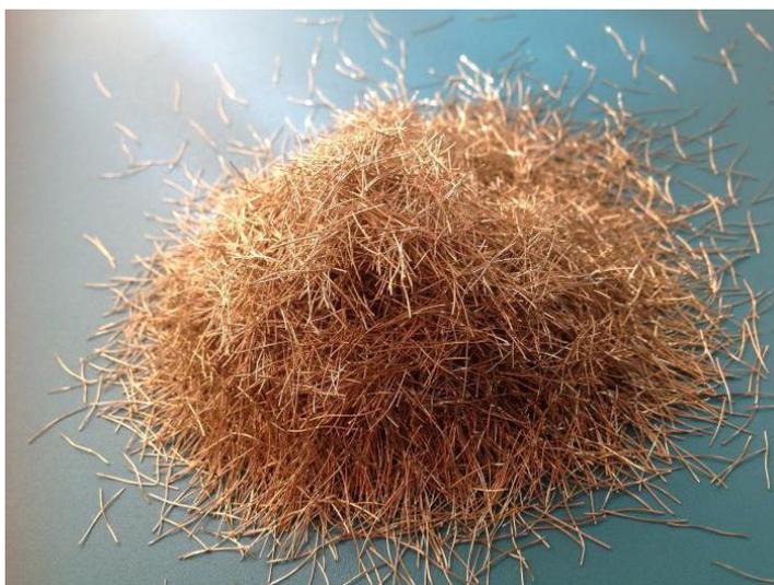
Рисунок 3 – Внешний вид металлической фибры
