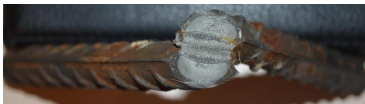
Рисунок 3 – Макрошлиф при сварке арматуры вкрест
