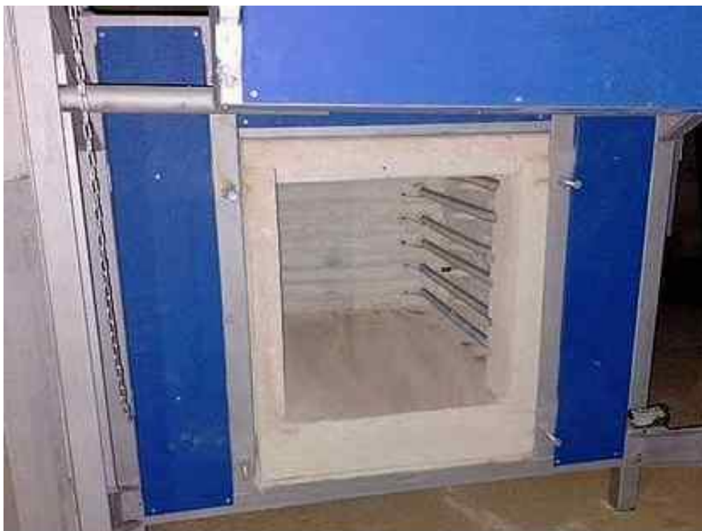
Рисунок 18 – Плиты ШВП-350 в печи
