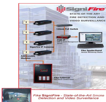
Рис. 3. Схема работы системы SigniFire [2]
