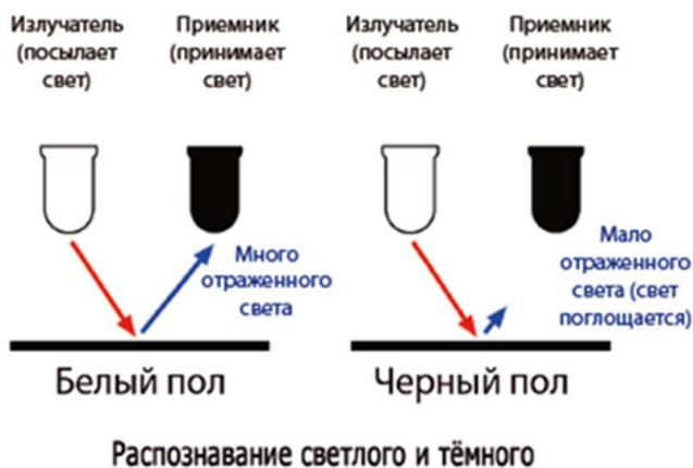
Рис. 1. Принцип работы ИК-датчика
