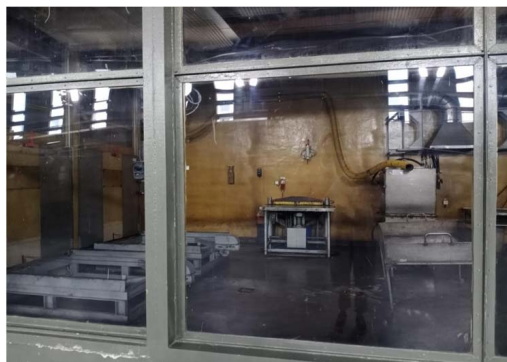
Рис. 1. Бокс сортировки и фрагментирования. Вид на окно приема РАО
