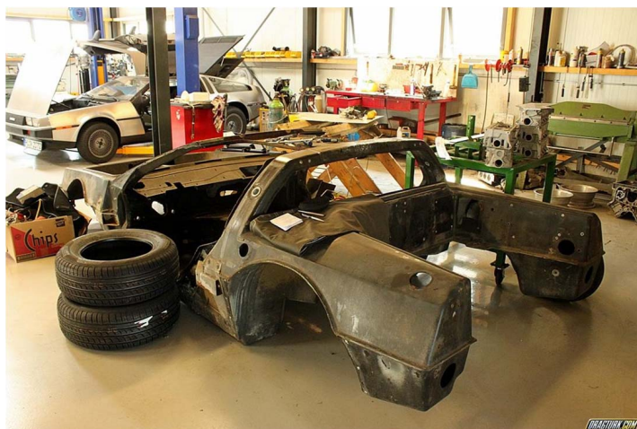
Рис. 2. Основа кузова DMC-12 – каркас из углепластика
