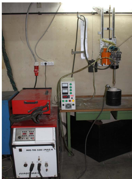
Рис. 1. Установка для получения алюминиевых лигатур при использовании легирующего компонента в виде плавящегося электрода (проволоки)
