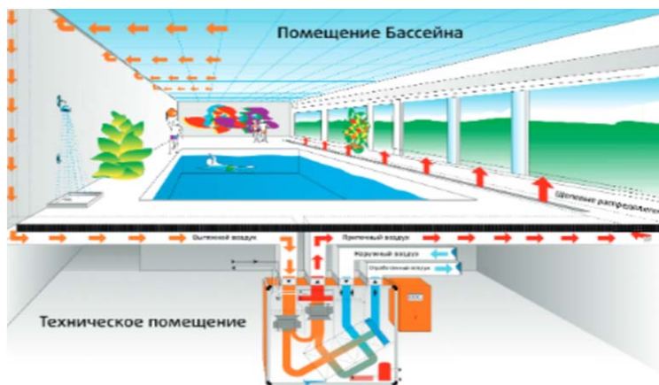
Рис. 1. Схема воздухораспределения в бассейне
