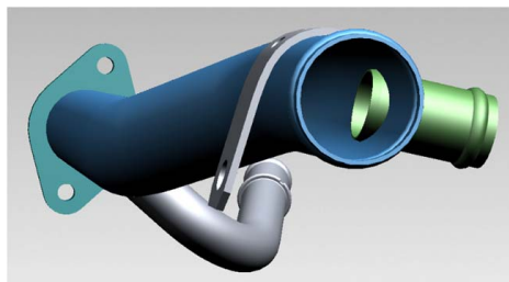
Рис. 2. Выступление патрубка во внутреннее пространство трубы ПВН
