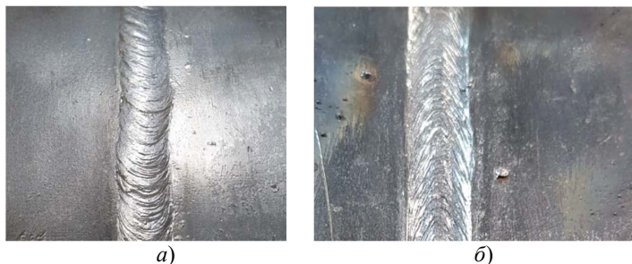
Рис. 1. Сварные швы, полученные РДС покрытым электродом при исследовании: a – сваркой «на подъем»; б – сваркой «на спуск»
