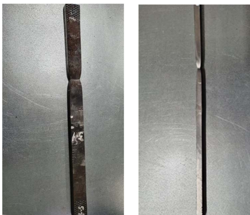
Рис. 3. Статическое разрушение образца при сварке «на спуск»
