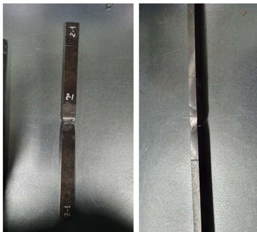
Рис. 2. Статическое разрушение образца при сварке «на подъем»
