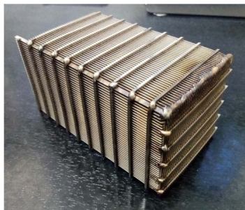
Рис. 2. Сварка плоских элементов
