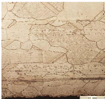
Рис. 2. Микроструктура БрАЖ 9-4 после закалки с 850 °С и отпуска при температуре 500 °С 15 мин
