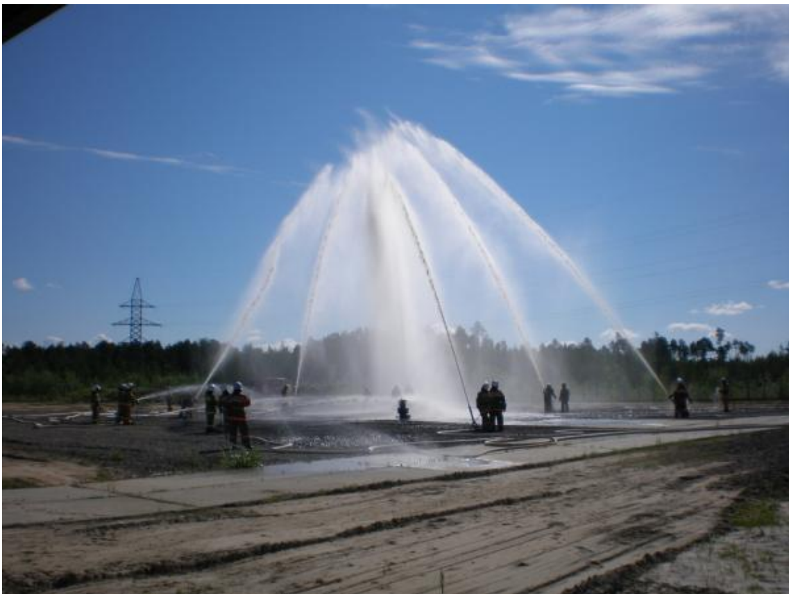
Рисунок 6 - Ликвидация горения фонтанов газоводяными струями
