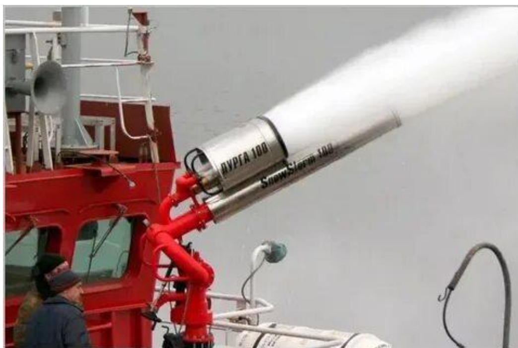
Рисунок 14 - Установка комбинированного пожаротушения «Пурга-100»
