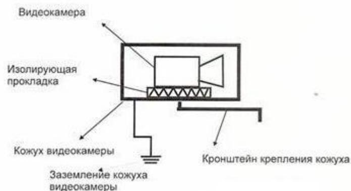
Рисунок 1.21 - способ установки видеокамеры.
