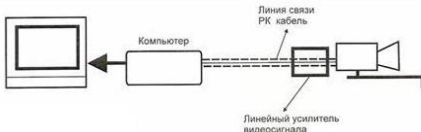
Рисунок 1.23 – схема подключения видеокамеры.
