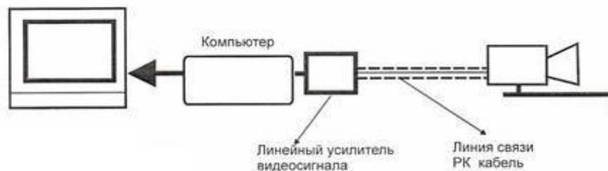
Рисунок 1.22 – схема подключения видеокамеры.
