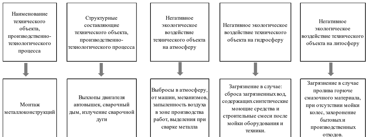
Рисунок Е.5 – Блок-схема отрицательных экологических факторов
