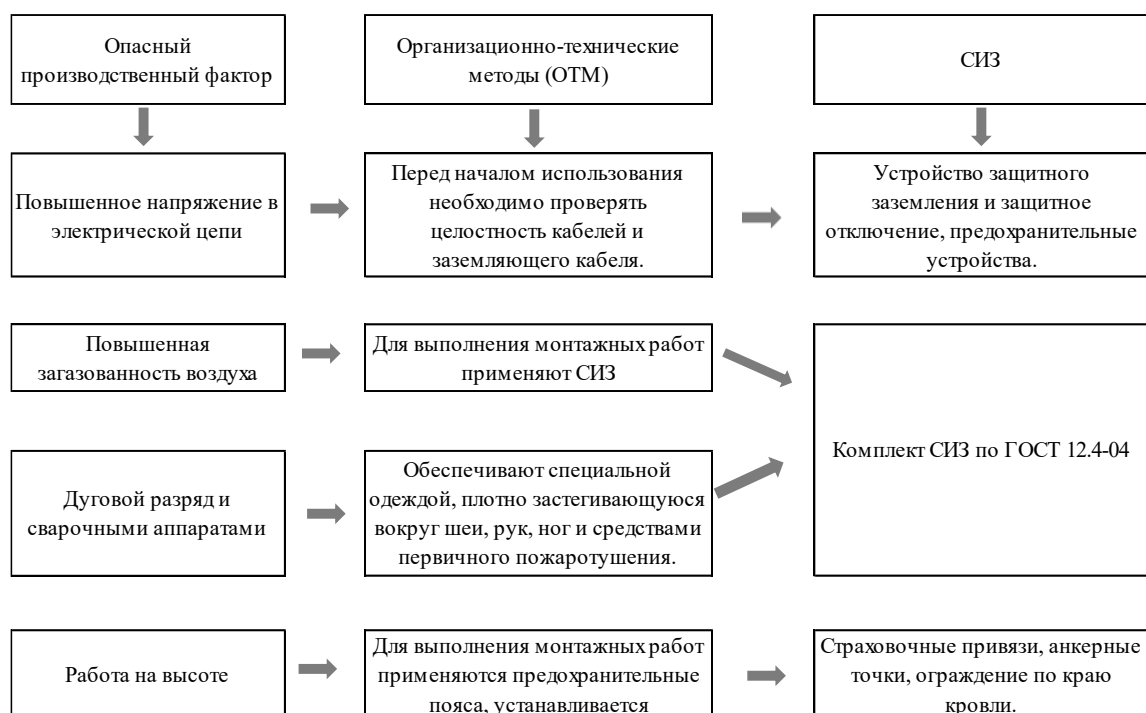
Рисунок Е.2 – Схема методов снижения производственных факторов
