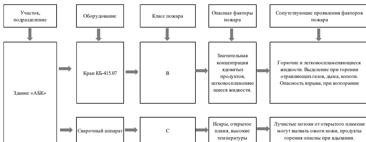
Рисунок Е.3 – Схема определения классов и опасных факторов пожара
