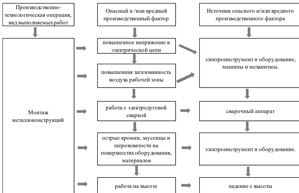
Рисунок Е.1 – Схема к определению производственных факторов
