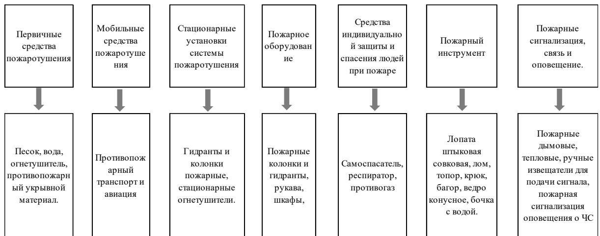
Рисунок Е.4 – Схема технических средств противопожарной охраны
