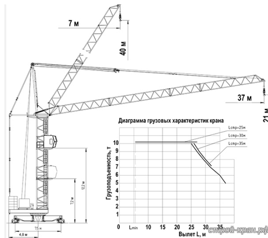
Рисунок 10 – Грузовые характеристики КБ-415.07
