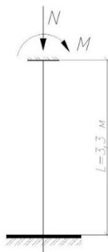
Рисунок 6 - Расчетная схема средней колонны цокольного этажа
