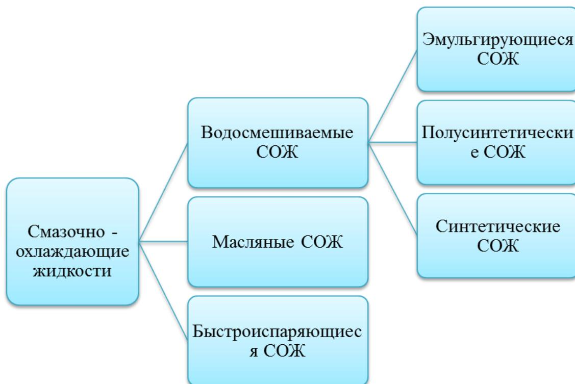
**Рисунок 1 - Классификация смазочно-охлаждающих жидкостей**
