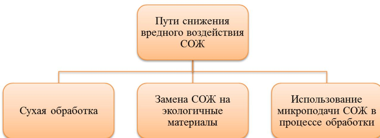
**Рисунок 9 - Снижение вредного воздействия СОЖ**
