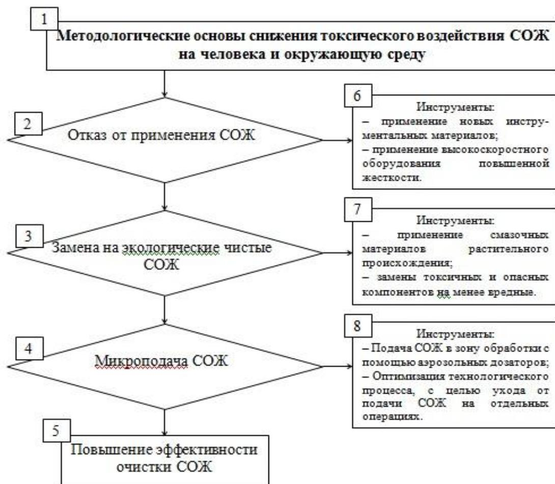
**Рисунок 11 - Основы снижения токсического воздействия СОЖ**
