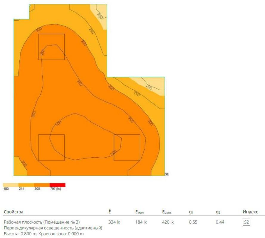
Рисунок 2 – Расчет уровней освещенности на рабочей поверхности для помещения №3
