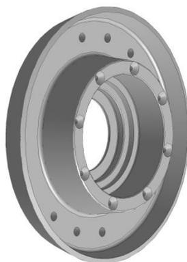
Рисунок 2 – Твёрдотельная модель нажимного диска
