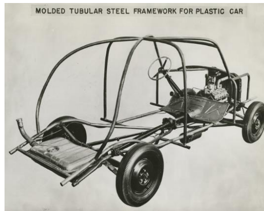
Рисунок 3 - Рама первого автомобиля с кузовом из пластика
