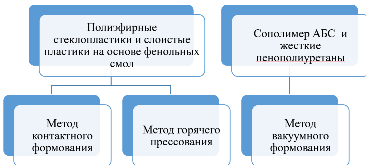
Рисунок 4 – Способы изготовления деталей автомобиля из пластика
