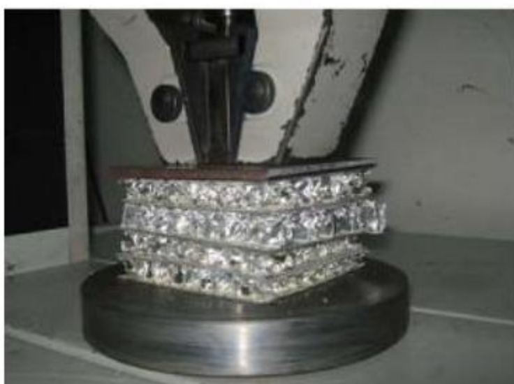
Рисунок 7 – Испытания сотового материала
