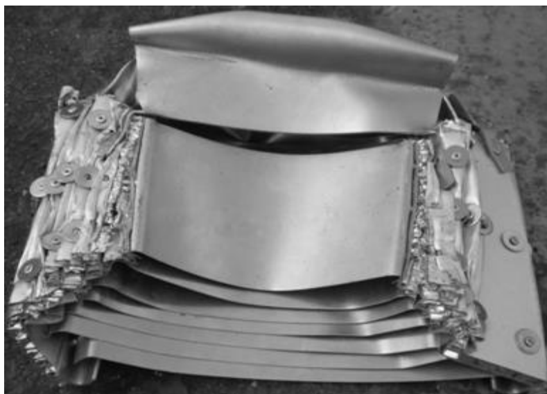
Рисунок 6 – Атенюатор после проведения испытаний
