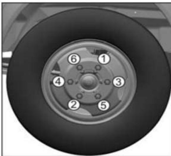
Рисунок 11 – Очередность затяжки гаек крепления колеса
