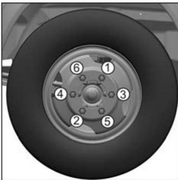
Рисунок 17 – Очередность затяжки гаек крепления колеса
