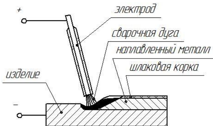
Рисунок 5 – Схема ручной дуговой наплавки штучным электродом
