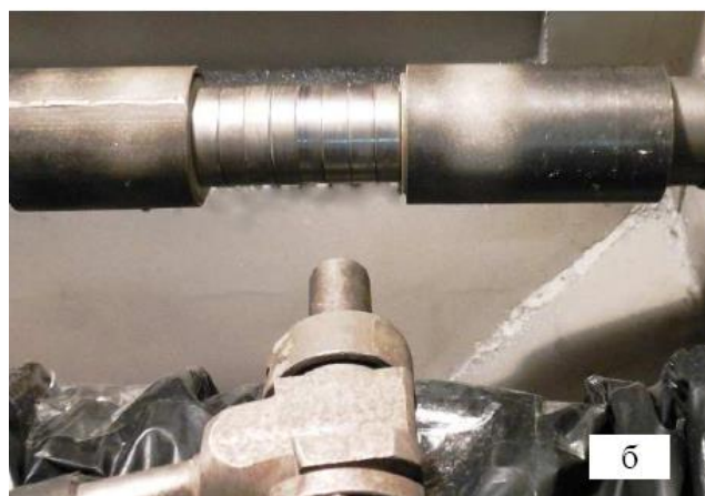
Рисунок 11 – Оборудование для пескоструйной обработки деталей вращения: компрессор с пескоструйной камерой (а); обрабатываемая деталь с соплом пескоструйного аппарата (б)
