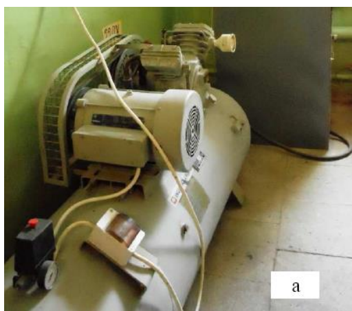
Рисунок 11 – Оборудование для пескоструйной обработки деталей вращения: компрессор с пескоструйной камерой (а); обрабатываемая деталь с соплом пескоструйного аппарата (б)
