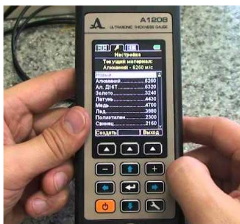
Рисунок 9 – Ультразвуковой толщиномер А1208
