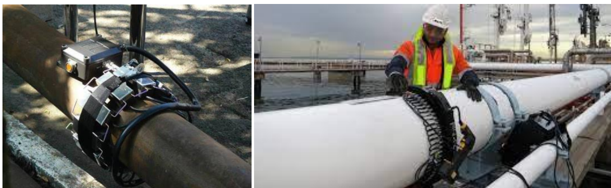
Рисунок 13 – Расположение датчиков и излучателей при низкочастотной ультразвуковой диагностике магистрального трубопровода
