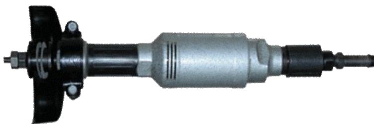
Рисунок 8 – Радиальная шлифовальная машина ИП-2014
