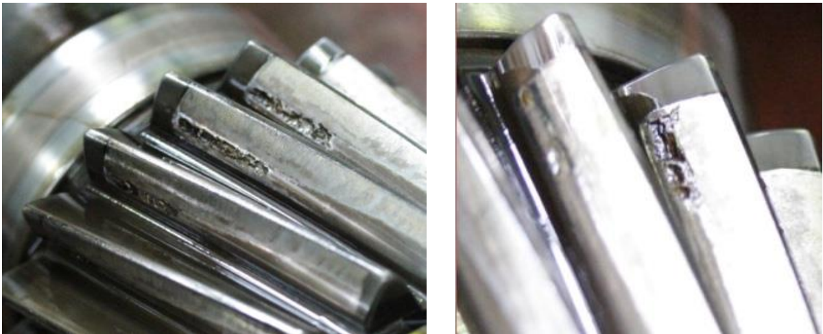
Рисунок 3 – Выкрашивание металла на шестерне зуба
