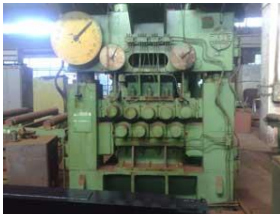
Рисунок 8 – Правка профильной трубы на правильной машине СКМЗ
