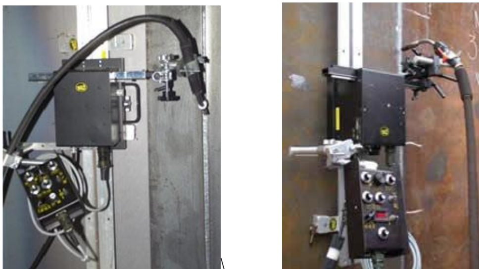
Рисунок 13 – Портативная каретка Universal для сварки вертикальных стыков резервуаров
