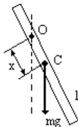
**Пример 12.** Маятник состоит из стержня ( $l = 30$  см,  $m = 50$  г), на верхнем конце которого укреплен маленький шарик (материальная точка массой  $m' = 40$  г), на нижнем – шарик ( $R = 5$  см,  $M = 100$  г). Определите период колебания этого маятника около горизонтальной оси, проходящей через точку  $O$  в центре стержня.
