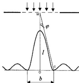
**Пример 7.** На дифракционную решетку нормально падает монохроматический свет с длиной волны  $\lambda = 600$  нм. Определите наибольший порядок спектра, полученного с помощью этой решетки, если ее постоянная  $d = 2$  мкм.
