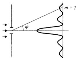
**Пример 5.** На узкую щель падает нормально монохроматический свет. Его направление на четвертую темную дифракционную полосу составляет  $2^\circ 12'$ . Определите, сколько длин волн укладывается на ширину щели.
