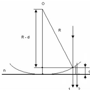
**Пример 12.** Установка для наблюдения колец Ньютона освещается монохроматическим светом, падающим нормально. При заполнении пространства между линзой и стеклянной пластинкой прозрачной жидкостью радиусы темных колец в отраженном свете уменьшились в 1,21 раза. Определите показатель преломления жидкости.
