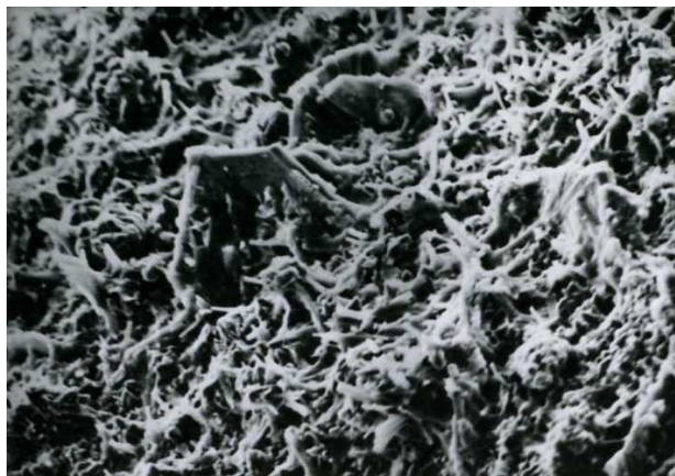
Рис. 6. Контактная поверхность заполнителя с короткими отдельными кристаллами этtringита (ув. 2000×). Разрушенный бетон жилого дома
