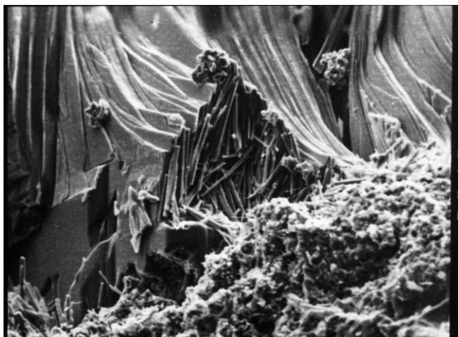
Рис. 11. Образование этtringита на поверхности зерна гипса, образец в возрасте 1,5 года (ув. 2000×)
