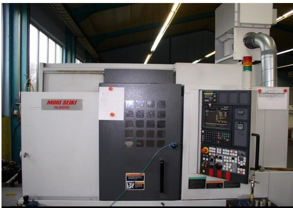
Рисунок 8 - Токарный обрабатывающий центр MORI SEIKI NL2000
