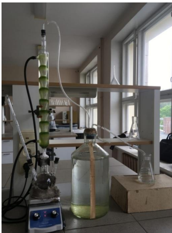
Рисунок 12 – Установка для определения каталитической активности формованного катализатора
