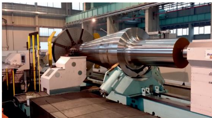
Рисунок 4 – Обточка поверхности прокатного валка
