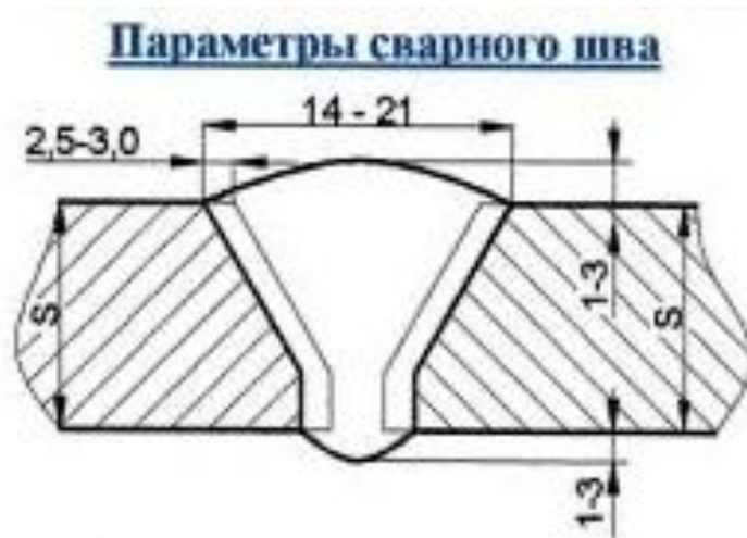
Рисунок 3 – Геометрия сварного шва
