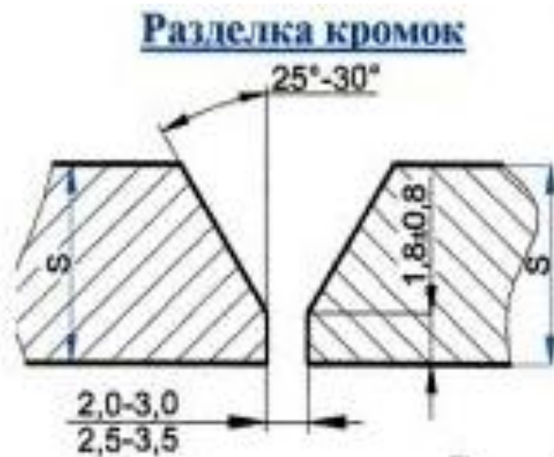
Рисунок 2 – Разделка кромок
