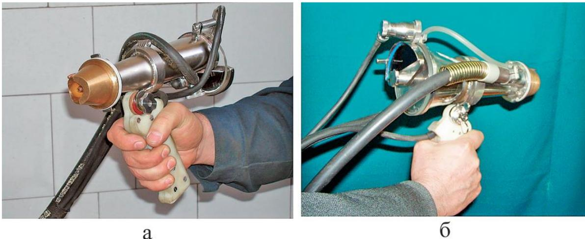
Рисунок 8 – Горелка для сварки плавящимся электродом в гибком мини-кессоне: со стороны сопла (а) и окна визуального наблюдения (б)
