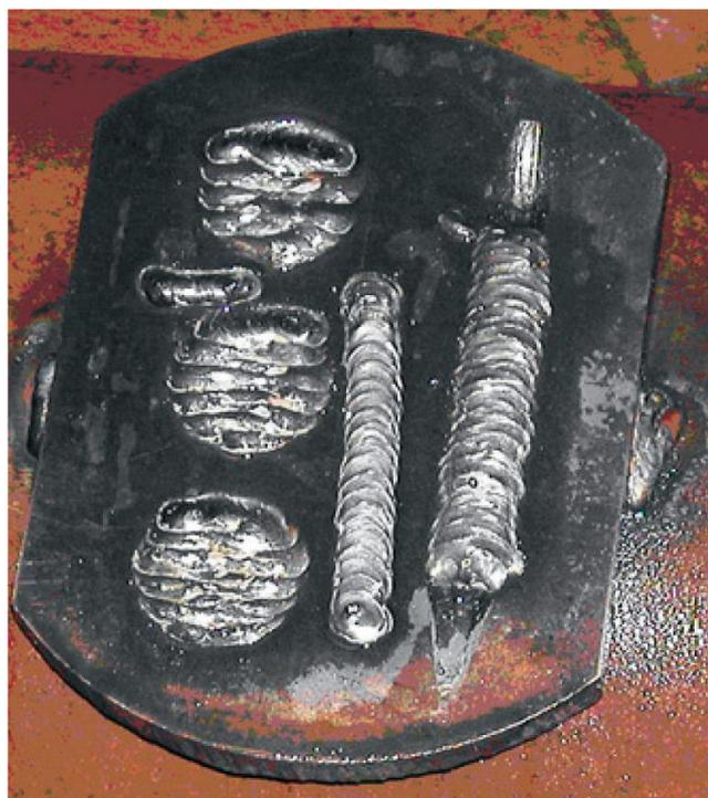
Рисунок 13 – Натурный образец наплавочных швов, выполненных установкой УПСС-1
