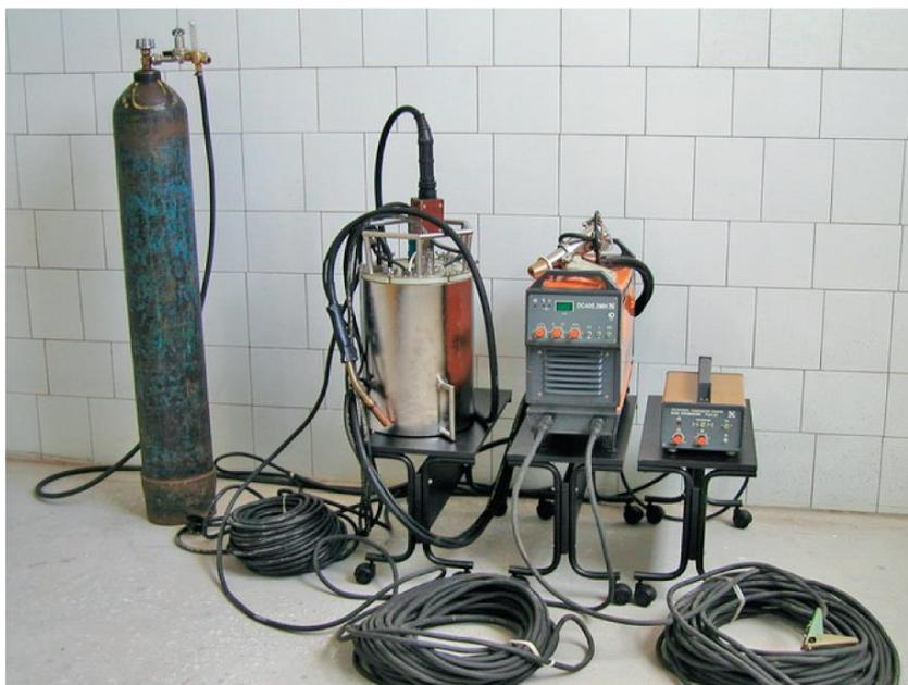
Рисунок 7 – Полуавтомат для подводной механизированной сварки
