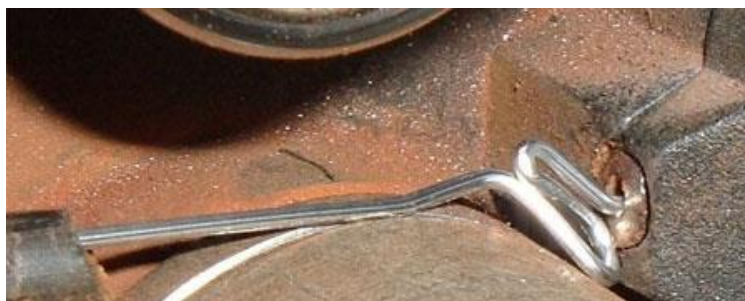
Рисунок 7 – Образование петель при подаче алюминиевой сварочной проволоки
