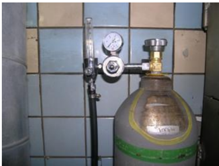
Рисунок 12 – Баллон для аргона, укомплектованный поплавковым ротамером и редуктором
