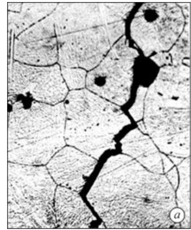
Рисунок 2 – Образование холодных трещин в металле сварного шва
