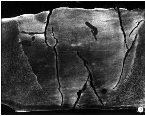
Рисунок 2 – Образование холодных трещин в металле сварного шва
