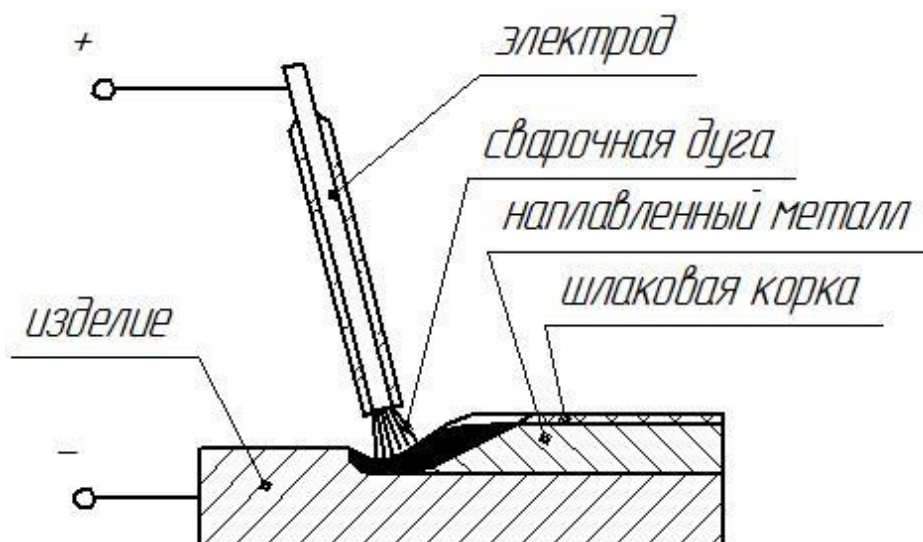
Рисунок 6 – Схема ручной дуговой наплавки штучным электродом
