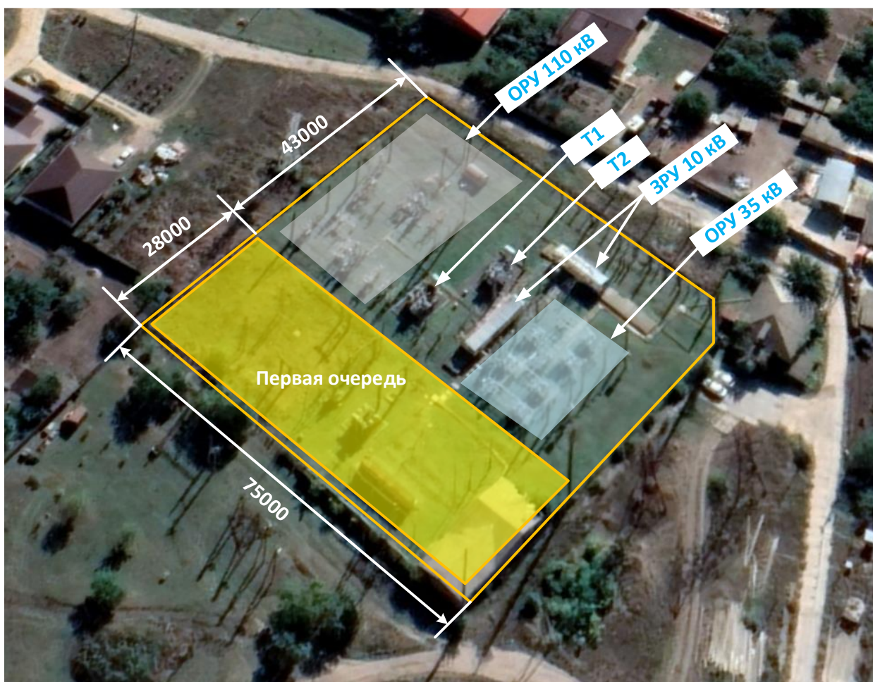
Рисунок 2 - План компоновки подстанции «Чалтырь» 110/35/10 кВ
